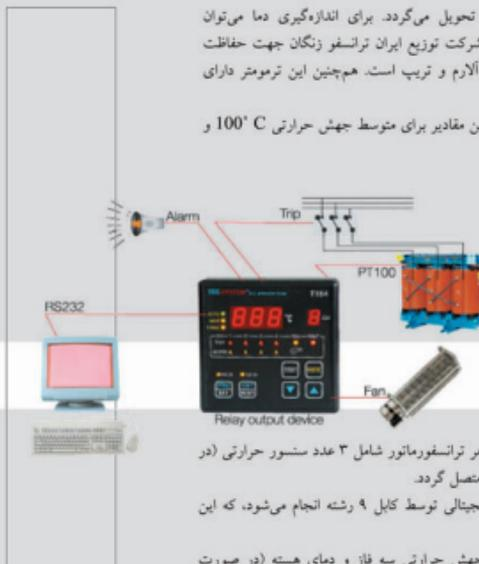
جهت کنترل دمای بویلین‌ها در ترانسفورماتور از رله ترمومتر استفاده می‌شود. هر ترانسفورماتور شامل ۳ عدد سنسور حرارتی (در هر فاز یک عدد) برای اندازه‌گیری دما می‌باشد که باید به رله ترمومتر دیجیتالی متصل گردد.
